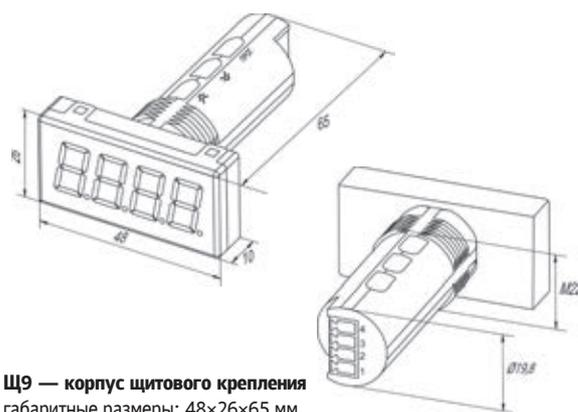
**Щ9 — корпус щитового крепления**
