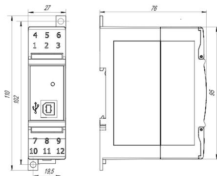
**Д1,5** — корпус для крепления на DIN-рейку
