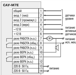
Общая схема подключения CAU-M7E
