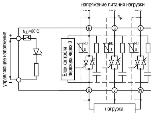
Схема включения серии HT-xx44.ZD3 (выходы – тиристоры)
