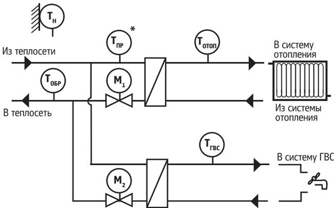
\* Вместо датчика T<sub>н</sub> может быть подключен датчик температуры прямой воды T<sub>пр</sub>, подаваемой из ТЭЦ.
