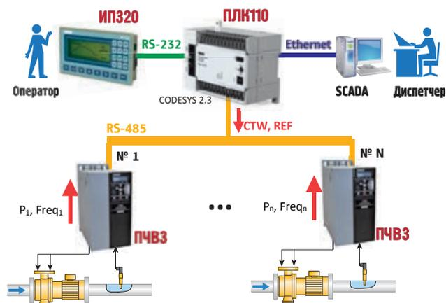
на работу с другим набором параметров). Все параметры частотных преобразователей доступны для чтения, все изменяемые параметры ПЧВ доступны для изменения по интерфейсу. Такой подход упрощает интеграцию ПЧВ в систему удаленного управления и диспетчеризации любой сложности.
