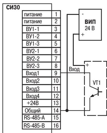
Подключение датчиков п-р-п-типа с открытым коллекторным входом (пассивный датчик).
