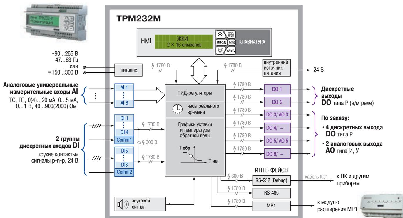
**РЕЖИМЫ РАБОТЫ И УПРАВЛЯЮЩИЕ ФУНКЦИИ КОНТРОЛЛЕРА ТРМ232М**
