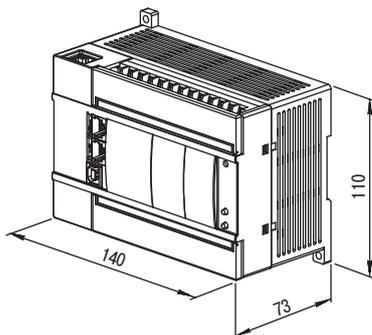
Габаритный чертеж корпуса ПЛК110-30, ПЛК110-32
