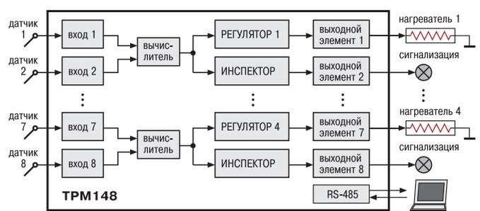
**Модификация 4.** 4 канала регулирования по ПИД- или ON/OFF-закону. Параллельно – контроль нахождения регулируемой величины в заданном диапазоне. Регулируемая величина может быть вычислена по результатам измерений одного или двух входов.
