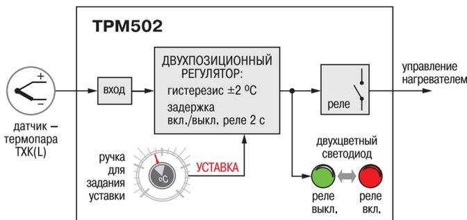
Двухпозиционный (ON/OFF) регулятор может использоваться для управления нагревателем или для сигнализации о том, что измеренная величина превысила уставку.
