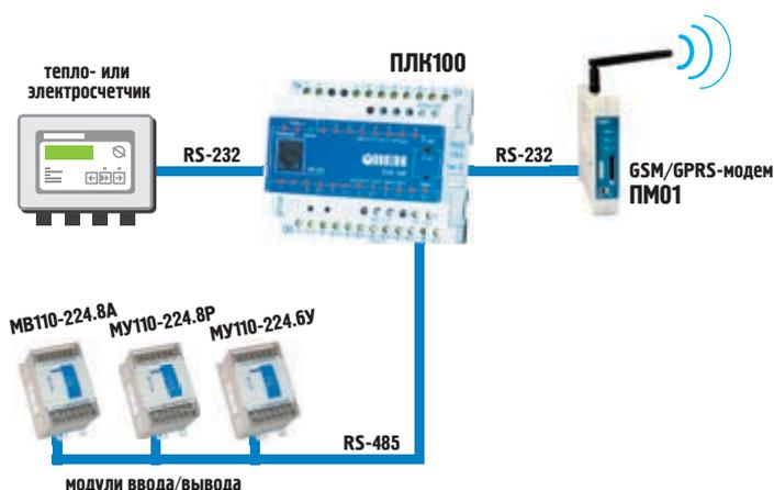
Построение системы управления удаленными объектами, включающей опрос тепло- и электросчетчиков и передачу данных через GSM-модем
