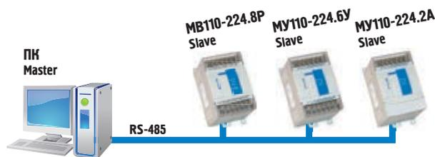
Подключение модулей Mx110 к ПК со SCADA-системой для удаленного ввода/вывода сигналов
