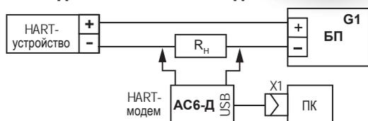
Предназначен для связи ПК или системных средств АСУТП с любыми интеллектуальными устройствами (датчиками давления, преобразователями температуры, расхода и т.д.), поддерживающими HART-протокол.
