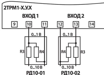
Пример подключения делителя обоих конструктивных исполнений к двухканальному измерителю-регулятору 2TRM1.
