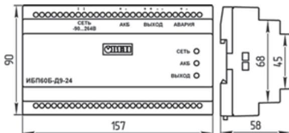
Предназначен для использования в качестве резервированного источника вторичного питания при работе от сети и от двух последовательно соединенных герметизированных свинцово-кислотных аккумуляторов.
