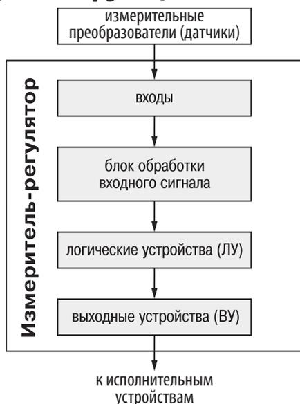
Измерители-регуляторы температуры состоят из следующих функциональных блоков (см. рисунок):
