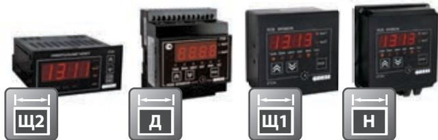
Применяется в качестве таймера, устройства задержки включения или формирователя последовательности импульсов, длительность которых задается пользователем (управление конвейером, прессом и т.п.).
