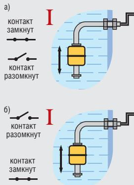
Повышение уровня жидкости в резервуаре приводит к перемещению поплавка вверх и замыканию/размыканию контакта датчика уровня.
