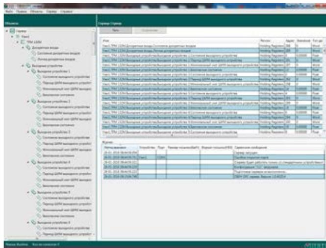
ОВЕН ОПС-сервер применяется для работы с устройствами ОВЕН. Программа содержит готовую библиотеку оборудования ОВЕН, что сокращает время настройки устройств в ОПС-сервере. Возможность работы с оборудованием других производителей, поддерживающих обмен по протоколу Modbus RTU/ASCII.
