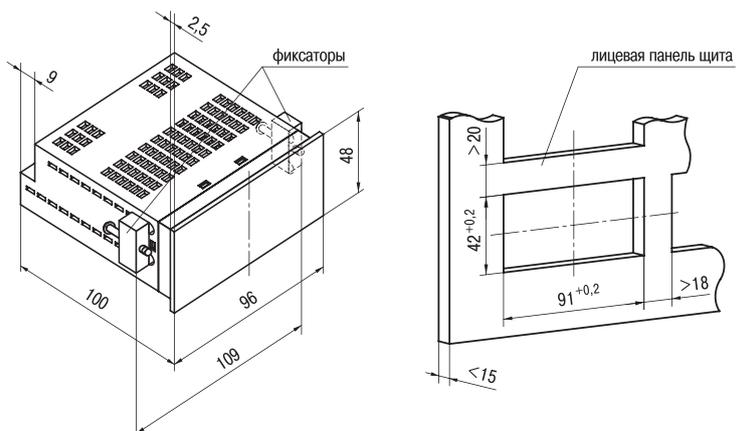
**Щ2 — корпус щитового крепления**
