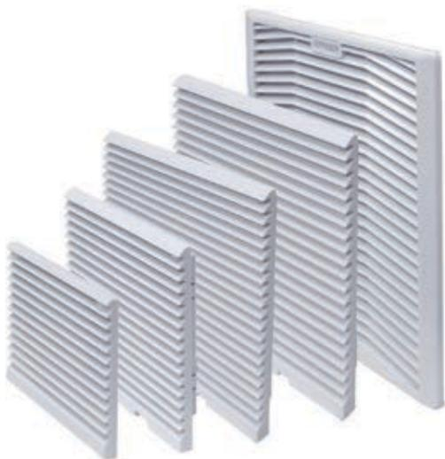
Выпускные решетки KIPVENT с фильтрами используются совместно с впускными решетками KIPVENT с вентиляторами для обеспечения принудительной или естественной вентиляции шкафов управления. Снабжены сменным фильтром, предотвращающим попадание пыли внутрь шкафа. Устанавливаются в боковую стенку или дверцу шкафа.
