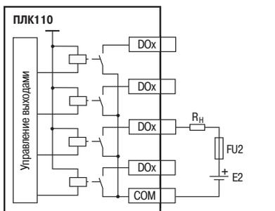
Схема подключения выходных элементов типа Р с внешними цепями защиты
