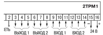
Схема расположения и назначение клемм ТРМ202
