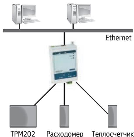
Опрос устройств с последовательным интерфейсом несколькими ПК, находящимися в сети Ethernet.
