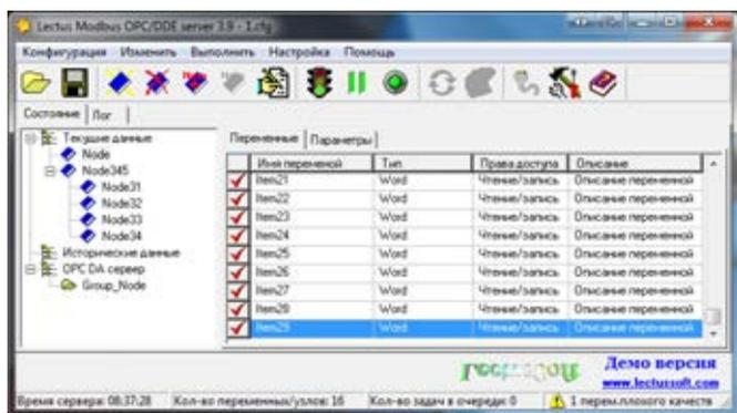
Modbus OPC/DDE-сервер Lectus предназначен для предоставления данных OPC- или DDE-клиентам от приборов, работающих по протоколу Modbus.
