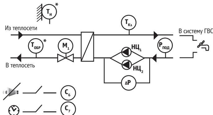
\* Датчики Tн и Tобр подключают, если необходима функция контроля температуры обратной воды (по умолчанию в контуре ГВС функция отключена).
