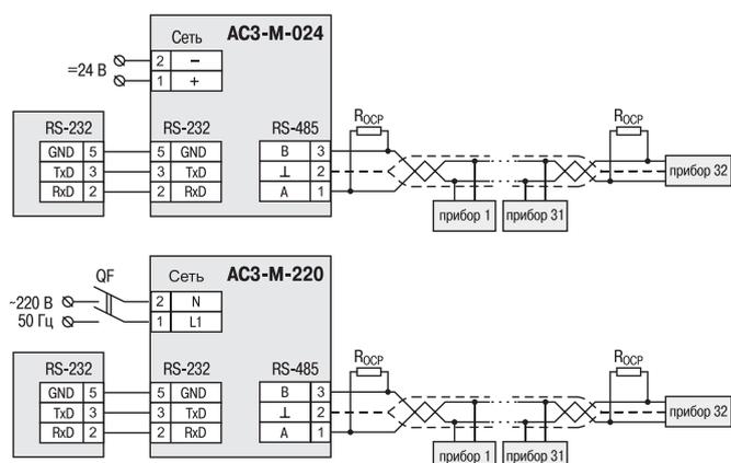
При построении сети с использованием интерфейса связи RS-485 к линии, выполненной витой парой, может быть подключено до 32 приборов, что ограничивается нагрузочной способностью АС3-М. При использовании повторителя RS-485 (АС5) к преобразователю АС3-М можно подключить более 32 приборов (до 256). АС3-М имеет встроенные согласующие резисторы сопротивлением 100 и 120 Ом.
