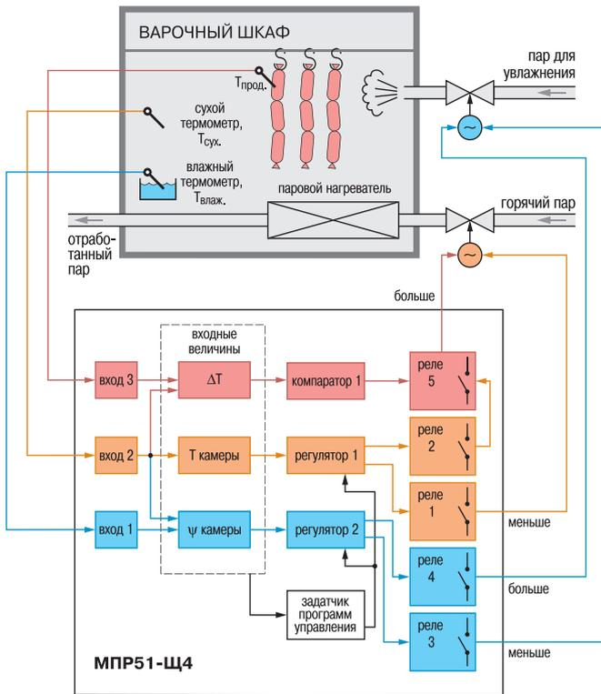
**Пример 1. Управление температурно-влажностным режимом варочного шкафа**
