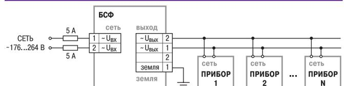
Количество подключенных к БСФ приборов или блоков должно соответствовать максимальному току нагрузки:
