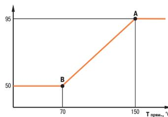
Пример графика температуры обратной воды —  $T_{обр.мах} = f(T_{прям.})$
