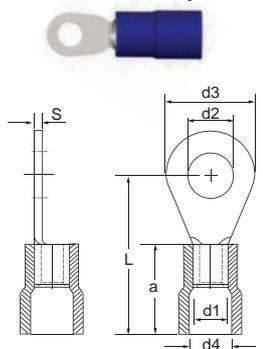
Предназначен для подключения проводов к электрооборудованию с контактными устройствами на основе винтовой фиксации.
