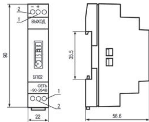
**Д1** — корпус для крепления на DIN-рейку
