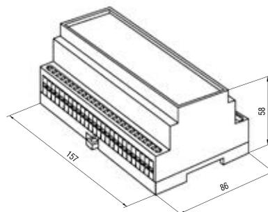
**Д9** — корпус для крепления на DIN-рейку 35 мм,
