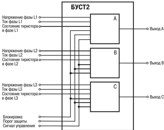
Каждый канал управления состоит из устройства контроля перехода напряжения фазы через ноль, устройства контроля состояния тиристора, устройства контроля тока фазы, устройства обработки сигнала, формирователя импульсов однополярного тока управления.
