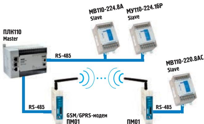
Использование Mx110 для увеличения числа входов-выходов ПЛК и для приема/передачи данных через GSM-модем
