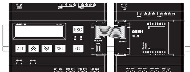
Модуль расширения ОВЕН ПР-М предназначен для увеличения количества дискретных входов и выходов программируемого реле ОВЕН ПР200. Модули имеют внутреннюю гальваническую развязку и независимое питание, что обеспечивает дополнительную гальваническую развязку и повышает надежность системы. Можно использовать головное ПР и модули с разным типом питания.
