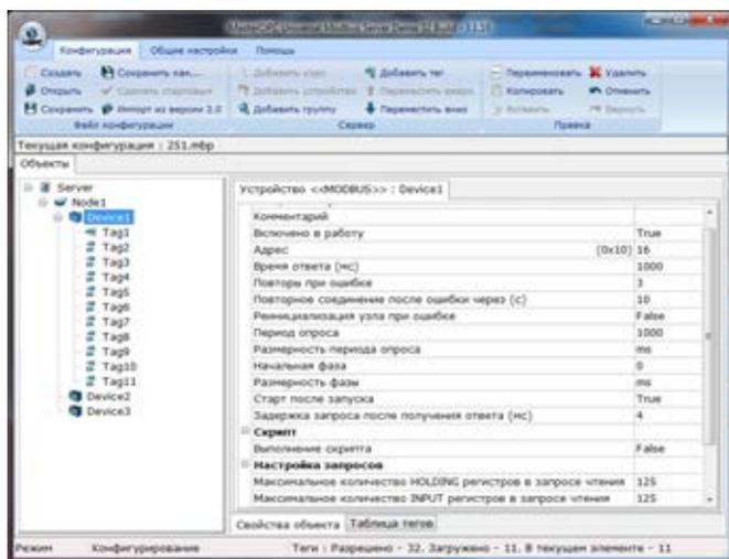
Данный OPC-сервер работает по протоколам Modbus RTU, Modbus ASCII и Modbus TCP. MasterOPC реализует два набора OPC-интерфейсов: DA (Data Access – текущие данные) и HDA (Historical Data Access – архивные данные). Для организации хранения архивов опрашиваемых переменных MasterOPC использует встроенный SQL-сервер.
