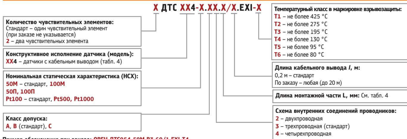
Пример обозначения при заказе: **ОВЕН ДТС054-50М.В3.60/1.ЕХІ-Т4**
