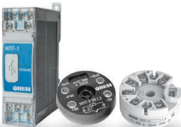
Преобразователи НПТ измеряют сигналы термопар или термометров сопротивления, формируют унифицированный сигнал тока 0(4)...20 мА. Преобразуют сигналы с разнотипных датчиков температуры в унифицированные, повышают помехоустойчивость линий связи, позволяют увеличить длину соединительных проводов и разветвить измеренную температуру на несколько контроллеров или приборов.
