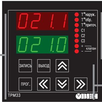
Кнопка **ПРОГ.** предназначена для перехода в режим **ПРОСМОТР**, а из режима **ПРОСМОТР** — в режим **ПРОГРАММИРОВАНИЕ**.
