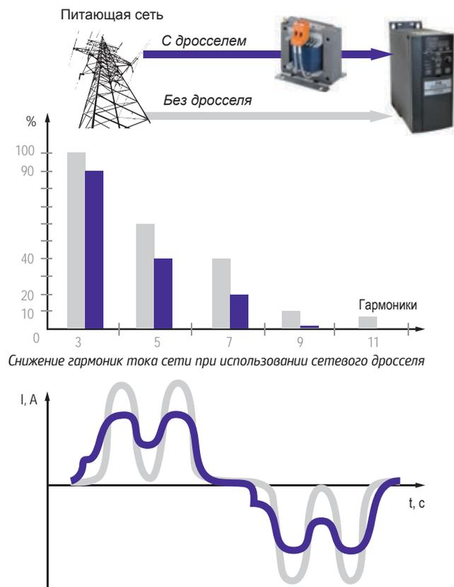
Сетевые дроссели (реакторы) устанавливаются в силовых цепях питания преобразователей частоты для снижения взаимного вредного влияния ПЧВ и сети.
