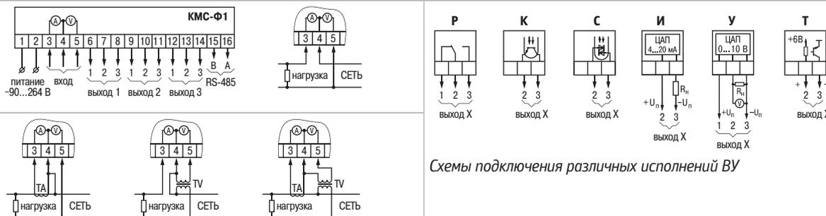
Схемы подключения различных исполнений ВУ
