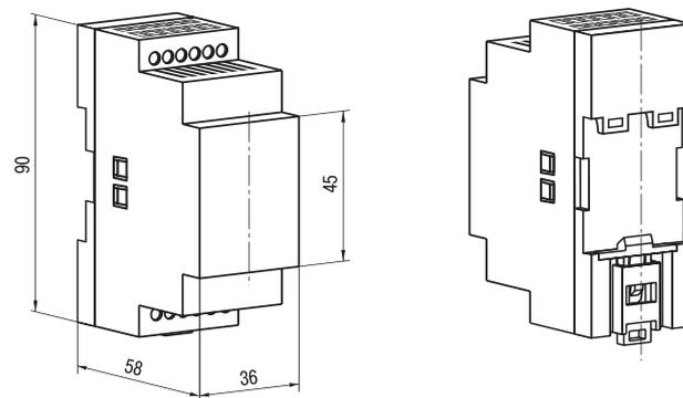
**Д2** — корпус для крепления на DIN-рейку 35 мм
