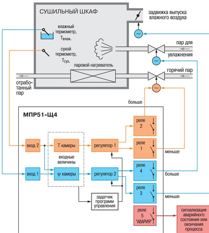
**Пример 2. Управление температурно-влажностным режимом в процессе сушки**
