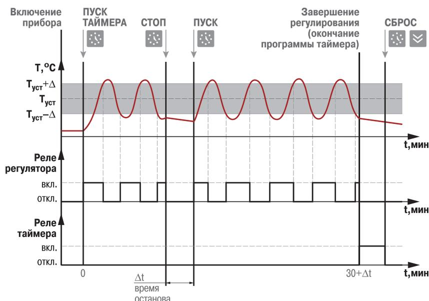
После включения в сеть для запуска таймера необходимо нажать кнопку . При этом начнется регулирование.
