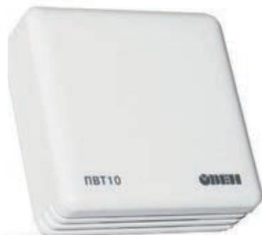
ОВЕН ПВТ10 предназначен для непрерывного преобразования относительной влажности и температуры воздуха в два унифицированных выходных сигнала 4...20 мА, а также передачи измеренных и вычисленных значений по интерфейсу RS-485 (Modbus RTU).
