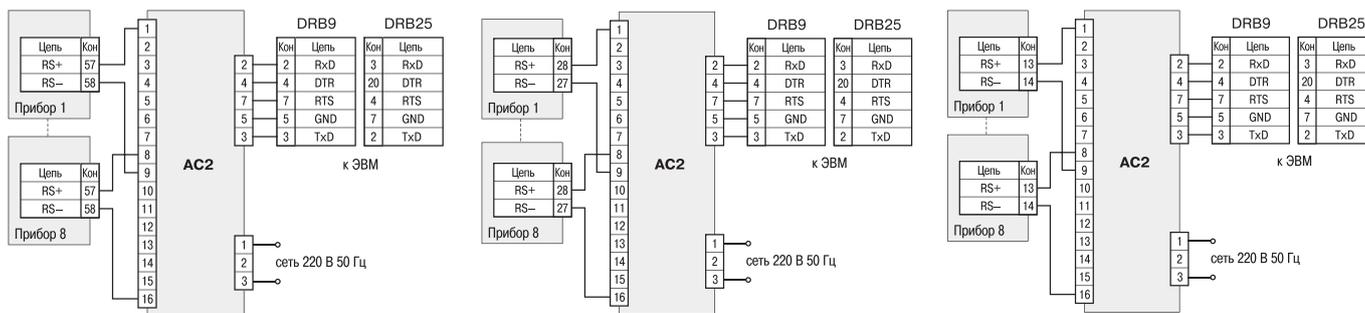
Схема подключения приборов ТРМ32, ТРМ33, УКТ38-В, УКТ38-Щ4
