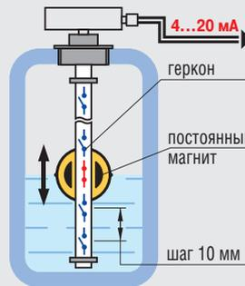
Магнитный поплавковый уровнемер конструктивно состоит из измерительного стержня и магнитного поплавка, перемещающегося вдоль стержня. Внутри стержня установлены герконы с шагом 1 геркон на 10 мм длины. При изменении вертикального положения поплавка в результате подъема или спада уровня жидкости изменяется выходное сопротивление датчика, которое преобразуется в аналоговый токовый сигнал 4...20 мА. Этот сигнал прямо пропорционален уровню жидкости.
