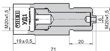
Предназначены для снижения пульсаций среды в измерительной полости преобразователя давления и защиты его от гидро- и пневмударов.
