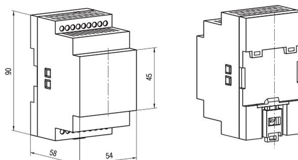
**Д3** — корпус для крепления на DIN-рейку 35 мм,
