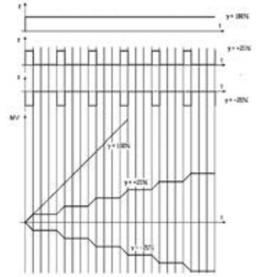
График сигналов на выходе ШИМ и ИМ при управлении средней скоростью регулирующего воздействия  $Y'$
