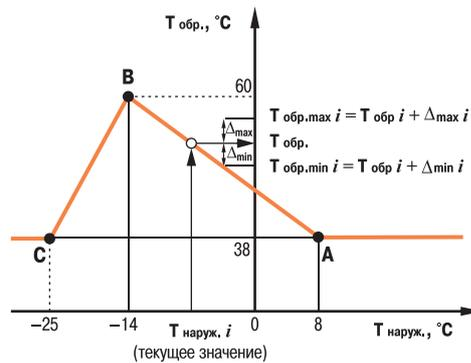
Пример графика температуры обратной воды —  $T_{обр.} = f(T_{наруж.})$
