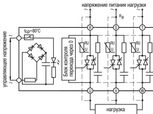
Схема включения серии HT-xx44.ZA2 (выходы – тиристоры)
