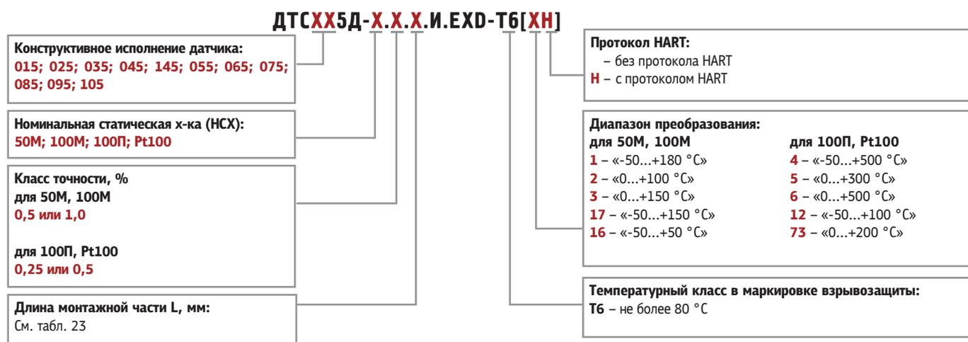
Пример обозначения при заказе: **ОВЕН ДТС045Д-Pt100.0.5.120.EXD-T6[4]**
