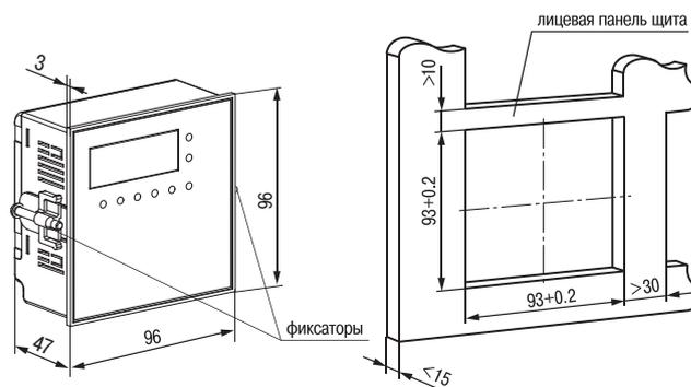
**Щ11 — корпус щитового крепления**
