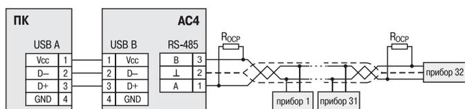
При построении сети с использованием интерфейса связи RS-485 к линии, выполненной витой парой, может быть подключено до 32 приборов, а при использовании повторителя RS-485 (АС5) – до 256 приборов.
