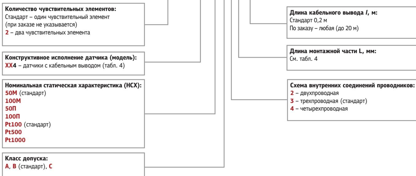
Пример обозначения при заказе: **ОВЕН ДТС054-50М.В3.60/1**
