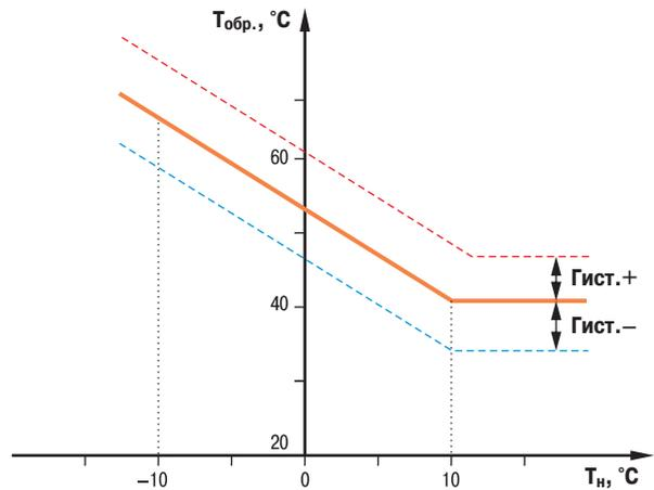
Если  $T_{обр.}$  воды > ( $T_{обр.}$  по графику + «Гист.+») (режим **ОБРАТНАЯ** при работе с ТЭЦ), то прибор подает команды на прикрытие регулирующего клапана.
