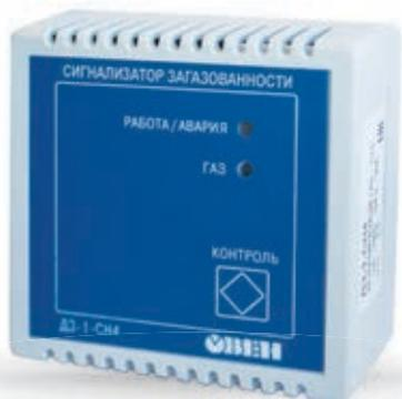
Прибор предназначен для непрерывного контроля концентрации природного газа метана (СН<sub>4</sub>) и сигнализации о превышении установленного порогового значения дозврывоопасной концентрации природного газа (НКПР) в воздушной среде газовых котельных, подвалов и гаражей. Прибор позволяет управлять газовым отсечным клапаном, сиреной, дополнительной световой сигнализацией, вентиляцией и т.п.
