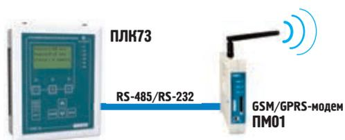
Подключение внешних устройств (например, GSM-модема)
