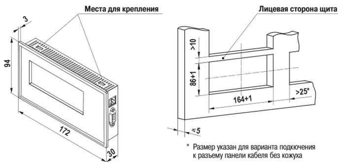
\* Размер указан для варианта подключения к разъему панели кабеля без кожуха
