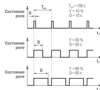
**Работа регулятора в системе с исполнительными механизмами постоянной скорости**
