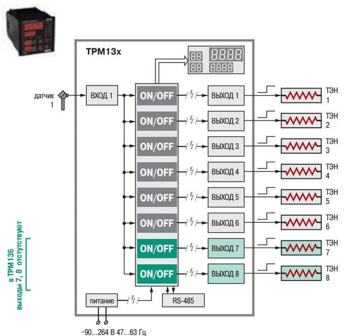
Одноканальный двухпозиционный регулятор с 6-ю или 8-ю уставками, может использоваться для контроля температуры одним датчиком и поддержания по двухпозиционному (ON/OFF) закону шести (восьми) независимых уставок.
