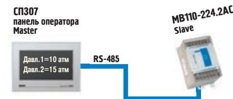
Подключение модулей Mx110 к панели оператора SP307
