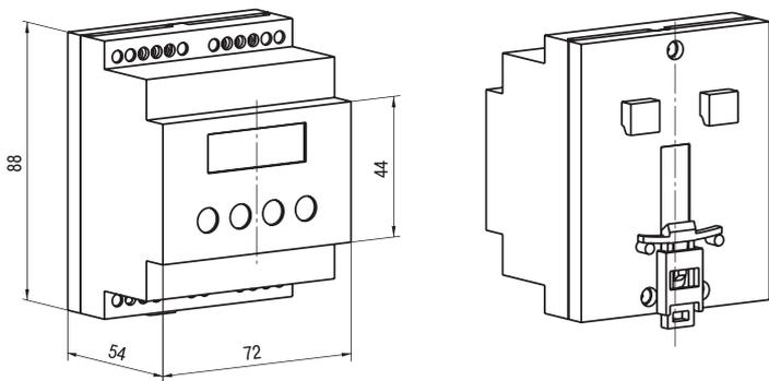
**Д** — корпус для крепления на DIN-рейку
