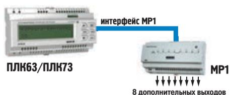
Расширение количества выходов путем подключения модуля MP1
