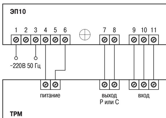
Схема подключения ЭП10 к терморегулятору
