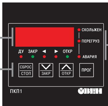
Два светодиода «ДВИЖЕНИЕ» красного цвета показывают направление перемещения задвижки. Светодиоды «ЗАКР.» и «ОТКР.» зеленого цвета показывают, что задвижка достигла конечного положения.
