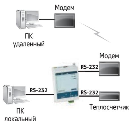
Передача информации с одного устройства с интерфейсом RS-232 на разные компьютеры: на локальный и удаленный, подключенный к ЕКОН через GSM-модем (например, ОВЕН ПОМО1).
