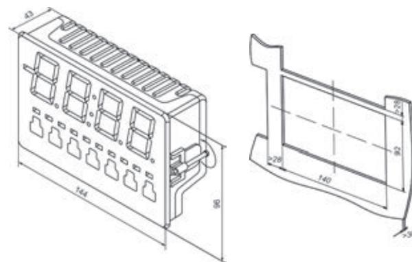
**Щ8 — корпус щитового крепления**
