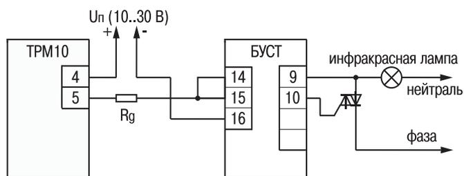
БУСТ может преобразовывать аналоговый сигнал в ФИМ-сигнал, что позволяет использовать его совместно с приборами ОВЕН, имеющими на выходе ЦАП «параметр-ток 4...20 мА». Например, для управления яркостью свечения инфракрасной лампы при сушке краски.
