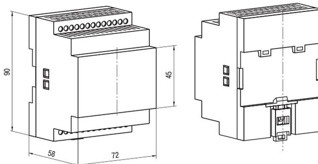
**Д4** — корпус для крепления на DIN-рейку 35 мм,
