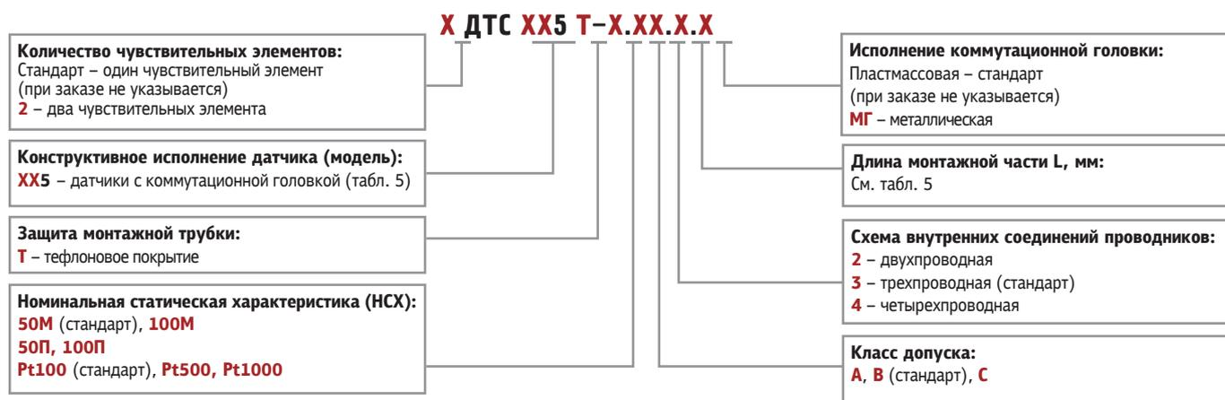
Пример обозначения при заказе: **ОВЕН ДТС035Т-50М.В3.80**
