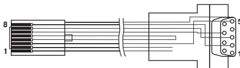
Схема кабеля для программирования KS14, входящего в комплект поставки ПЛК110[M02].
